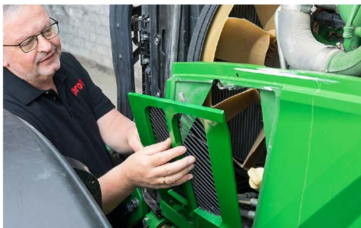
Wenn das Gitter nicht richtig verriegelt ist, kann es verloren gehen. Auch die Scheuerstellen am Lack sind sehr unschön.
