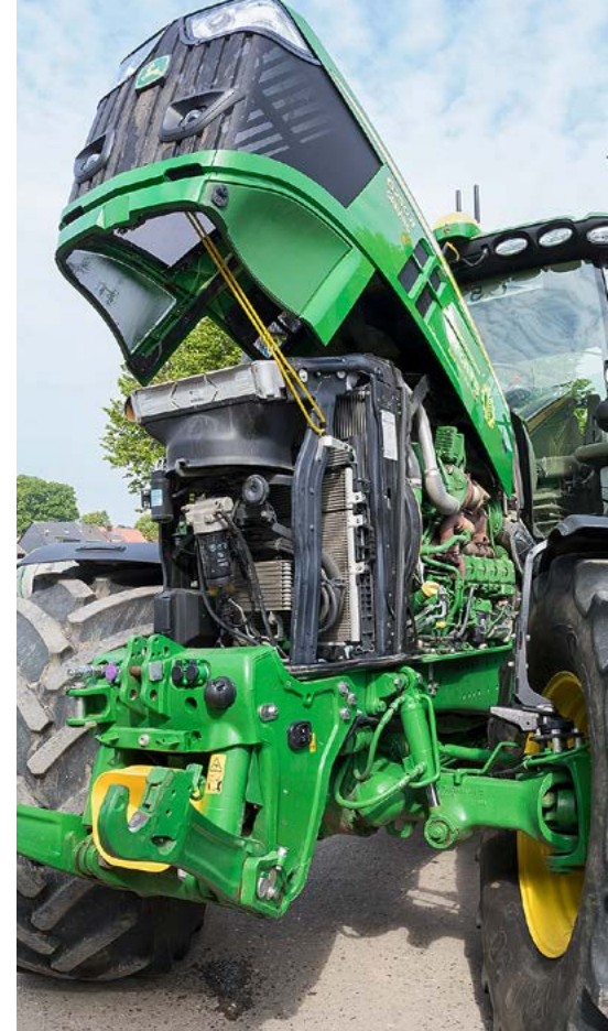
Die großen Kühler sind wartungsfreundlich, die Stickstoffblasen der Federung müssen schon mal geprüft werden.
