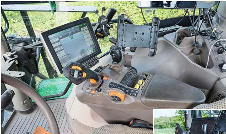
Joystick und Terminal suchen ihresgleichen in Sachen Logik und Bedienung. Leider kann der Tablet-Halter mit der Konsole kollidieren (unten).
