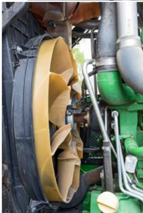
Der Motor ist sparsam und stark, der Visco-Lüfter musste allerdings nach gut 3 100 h erneuert werden.
